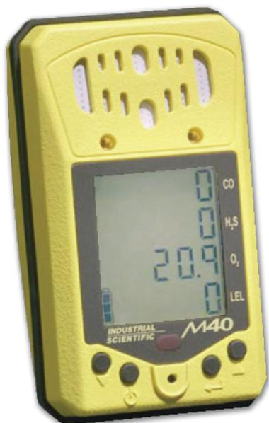
M40為一款具偵測CO,H<sub>2</sub>S,O<sub>2</sub>及可燃性氣體的多用途氣體監測器，主機裝置於堅固、耐衝擊之機殼中，並可阻隔無線電射頻(RFI)及電磁干擾(EMI)，且提供優良功能與惡劣環境中之可靠性，適用於危險多樣性及侷限空間場所。
